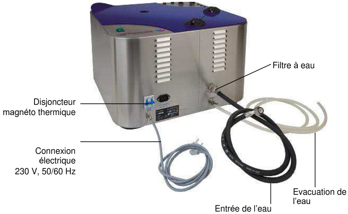
Fig 1: Partie postérieure de la machine avec les connexions.
