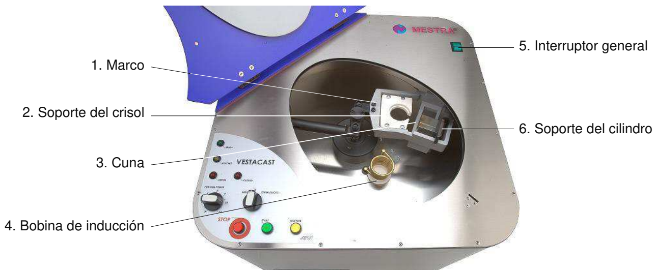
Fig. 2: Cámara de colado con el brazo
