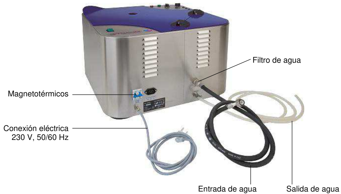
Fig 1: Parte posterior de la máquina con conexiones
