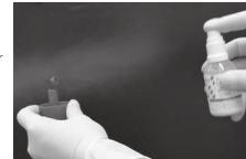
Un seul jet suffit (1x) sur la surface interne / externe de la maquette en cire. Garder une distance de 15cm pour une dispersion optimale de la pulvérisation. Les excès peuvent être enlevés en soufflant de l'air.
