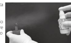
Spruzzare una sola volta (1x) sulla superficie interna/esterna del modello in cera. Mantenere una distanza di 15 cm per disperdere in modo ottimale lo spray. Il prodotto spruzzato in eccesso può essere rimosso con getto d'aria.
