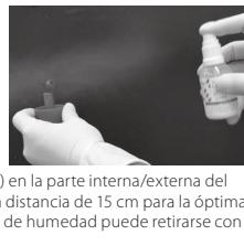
Agitar el bote de spray antes de usar. Rocíe solo una vez (1x) en la parte interna/externa del patrón de cera. Mantenga una distancia de 15 cm para la óptima dispersión del spray. El exceso de humedad puede retirarse con aire a presión.
