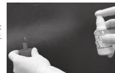
Spray kun én gang (1x) på den interne/eksterne overflade af voksmodellen. Hold en afstand på 15 cm for at få den optimale fordeling af sprayen. Overskydende materiale kan fjernes med luftspray.
