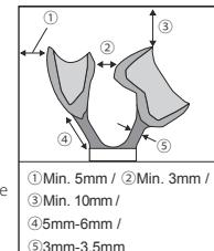
Hinweis: Bringen Sie die Gusskanäle immer in Fließrichtung des Keramikmaterials und am dicksten Bereich der Wachsmodellation an, damit die viskose Keramik während des Pressens ungehindert in jeden Bereich fließen kann.
