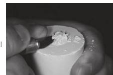
Tryck försiktig ut inbäddningsringen från cylindern. Använd en gipskniv för att slipa bottenytan (kontrollera 90°-vinkeln och att positionen är stabil).
