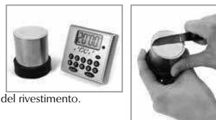
2. Raschiare la parte superiore del cilindro di rivestimento con una lama affilata.
