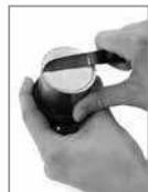
2. Kratzen Sie die obere Fläche des Muffelrings mit einem scharfen Messer an.
