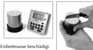
Kratzen Sie die obere Fläche des Muffelrings mit einem scharfen Messer an.
