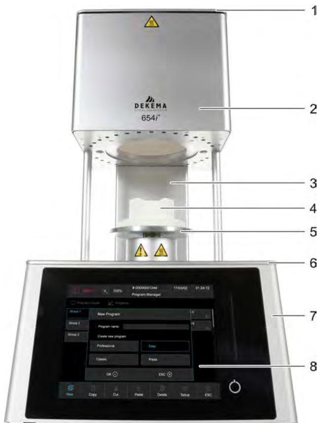
Fig. 3-1 Frontansicht des Brennofens (Beispiel AUSTROMAT® 654i®)
